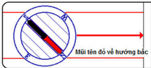
Hình 4- Quay người, bàn tay, toàn la bàn, cho đến khi kim-la-bàn trùng với những đường-định-hướng trong thân-la-bàn
